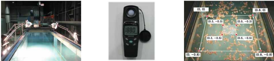
그림 2. 빛의 밝기에 따른 정확도 분석을 위한 실험 장치와 유속측정 영역
