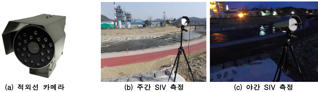
그림 3. 적외선 카메라를 이용한 SIV 측정
