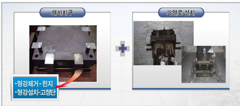
<그림 1> 재하가열실험을 위한 변동식 압축시험용 재하지그
