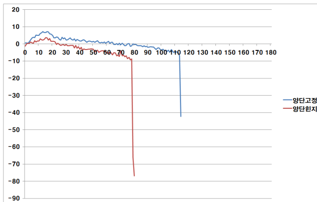
<그림 4> 경계조건 변화에 따른 변형특성 비교(축력비 0.6, 24MPa, 280단면)
