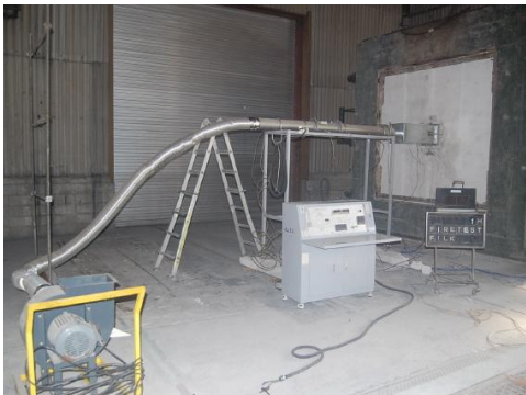
그림 4. 방화댐퍼 내화시험 모습
