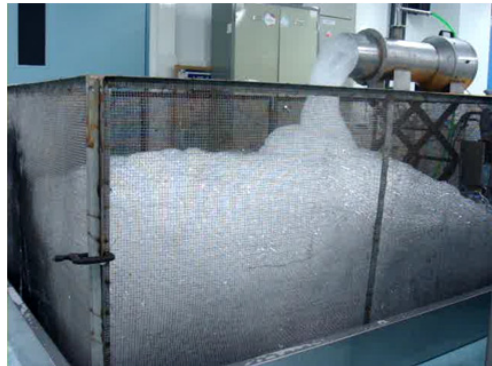
그림 2. 발포 성능 시험 모습
