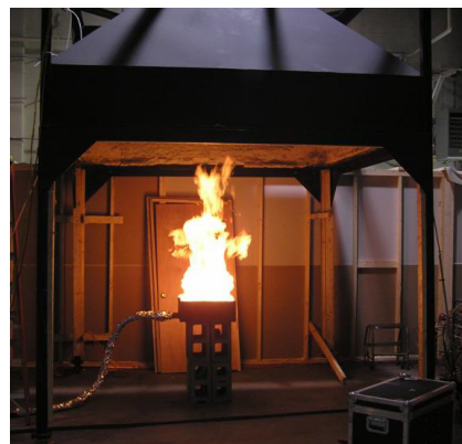
그림 1. 해석 대상 화재발열량계의 개략도와 사진
