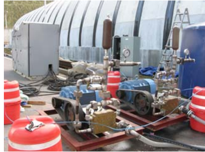
그림 4 고압 미분무수 급수 공급시스템
