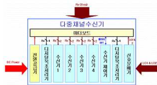
그림 1. 다중채널 수신기 구성도 Fig. 1. Configuration of multi channel receiver
