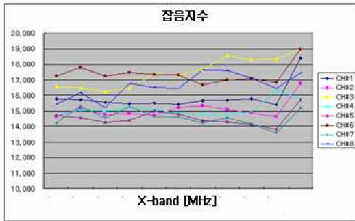
그림 10. 수신기(채널) 별 잡음 지수 Fig. 10. Noise Figure at each channel
