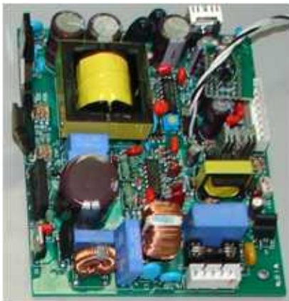
그림 4. 고해상력 투영시스템의 전원보드 Fig. 4. Power board of high-resolution inspection projector
