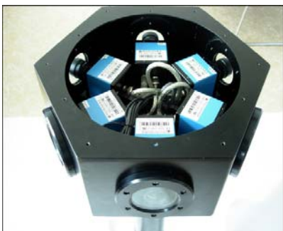
▶▶ 그림 2. 6대 카메라 배치 및 카메라 하우징
