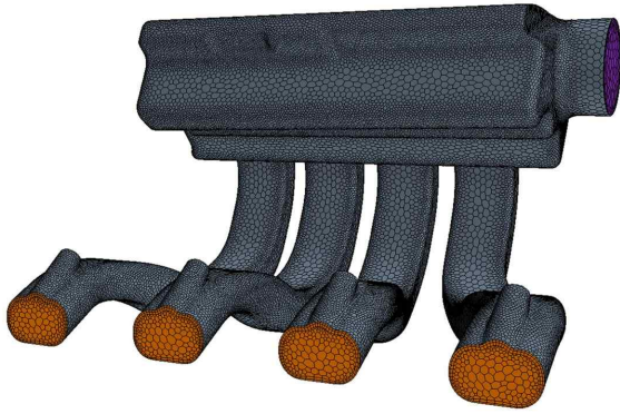
[그림 1] 3-D 해석 모델 및 해석 격자
