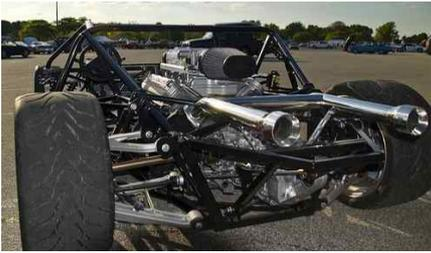
[그림 1] 경주용 자동차의 스페이스 프레임 사진
