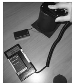
[그림 2] 외부 빛의 차단하고 조도계를 이용하여 LED의 조도를 측정하는 모습
