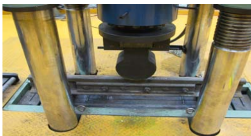
[그림 3.1] 접촉절연레일 굴곡시험
