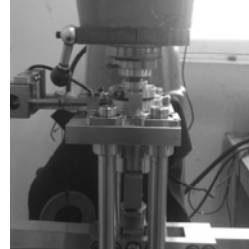
Fig.2 다목적 마찰 및 마모 시험기
