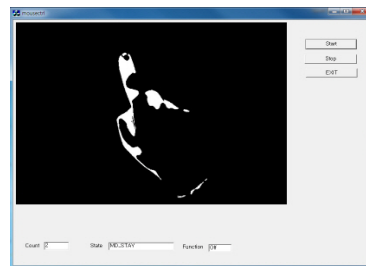
그림 16 검은배경에서의 정확도 실험 복잡한 환경에서의 마우스 제어는 많음 노이즈 때문에 포인터의 이동이 일정하지 않았다. 손가락 계수 파악에도 정확도가 낮아지게 되었다. 이진화의 영상의 임계값을 조절해보았지만, YCbCr 공간으로 변환 후 손의 인식이기 때문에 민감도가 높아 복잡한 환경에 적응할 수 없었다.
