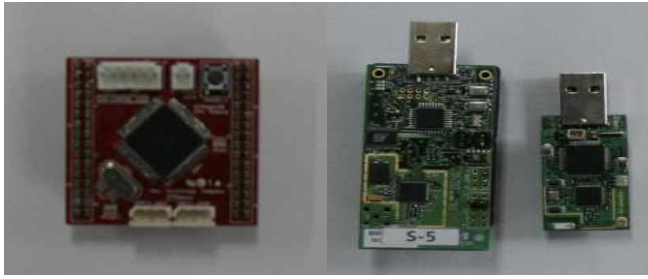
그림 1 Sirase Algorithm을 구현한 Atmega128보드
