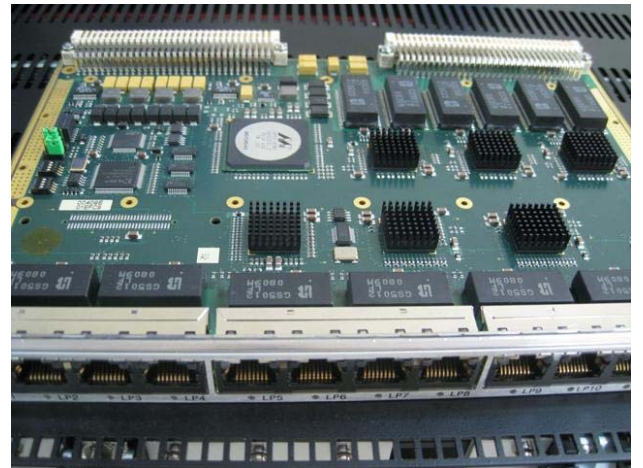
[그림 12] FP 210/024 Ethernet Switch Board
