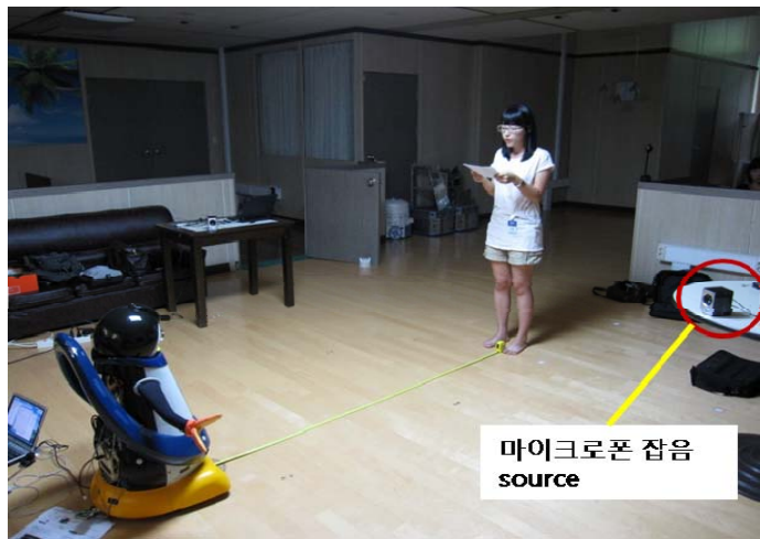
그림 4 잡음과 음성이 동시에 모바일 플랫폼(로봇)에 장착되어 있는 마이크로폰에 입력된다. 이 때, 목적음성과 잡음은 서로 다른 각도에서 입력된다.
