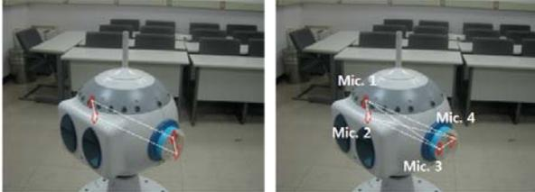
그림 1. (좌) 기존의 로봇 인공귀에 부착된 마이크론의 배치 (우) 변경된 마이크론의 배치
