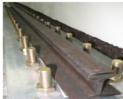
Fig. 1. Rail and its supports for measuring dynamic 진 가속도 신호를 이용하여 전달함수를 구한 후 wave number 를 수치해석적으로 구해 지지단의 스프링 상수를 구해야 한다. 본 연구에서는 지지단
