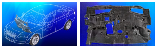
그림 1. Dash isolation pad 장착위치 및 제품형상
