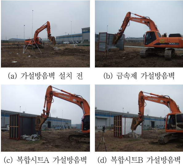
그림 2. 옥외 삽입손실 측정 전경
