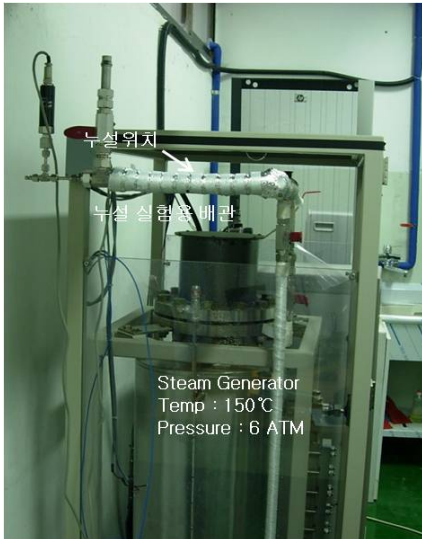
Fig. 3 초기누설 영상신호 취득을 위한 증기발생기와 단열재에 쌓인 실험용 배관
