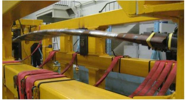
그림 3. 공진현상에 의한 블레이드 변형 형상
