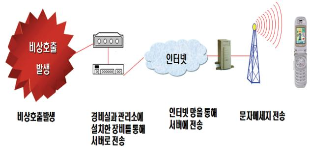
그림3. 비상호출 전체 시스템 구성도
