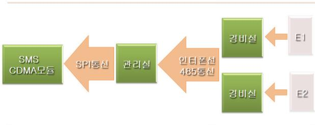
그림5. SMS 전송시스템 개략도
