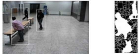
(a) 관심영역 병합 (b) 병합 관심영역에 대한 워터셰드와 배경차감결합영상 (그림 5) 관심영역 병합과 워터셰드 처리 결과 영상
