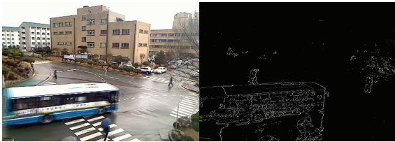
(그림 1) 누적 차영상을 이용한 배경영상(좌)과 차영상(우)
