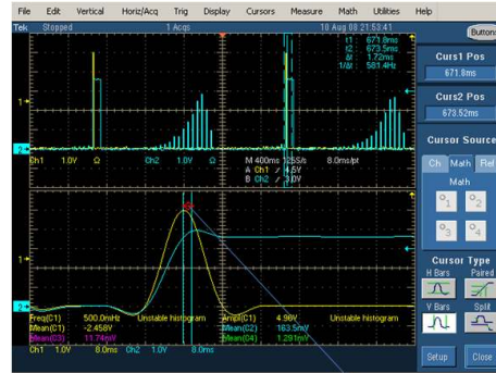
그림 3. 순간 동작을 위한 응답속도 측정
