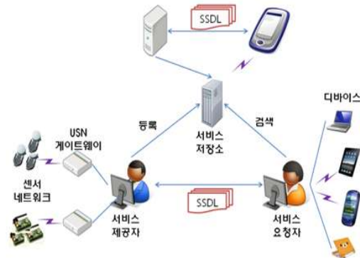
그림 2. USN 응용 서비스를 위한 참조모델 구조
