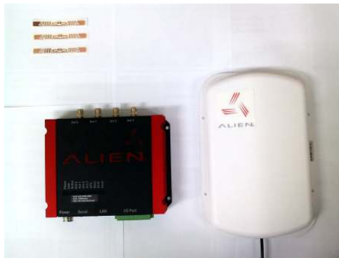
그림 2. 자재의 정보를 수집하는 RFID Tag와 Reader
