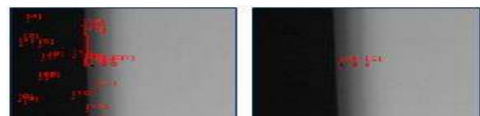
그림 5. 결함 후보영역 및 결함 검출 결과
