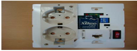
그림 8. 아울렛 센서와 ZigBee 통신 [피에스디테크]
