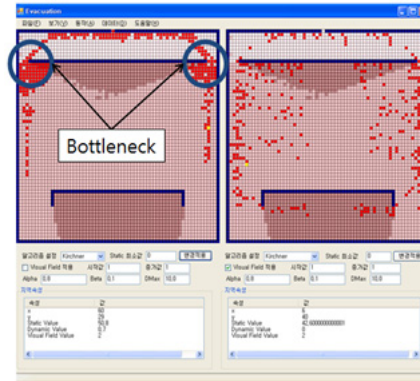
그림 3. 기존 floor field 모델과 visibility field가 추가된 모델의 비교
