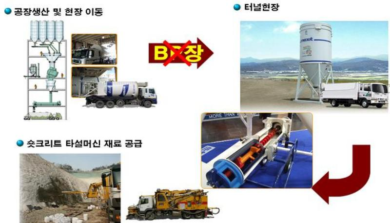
그림 1. 레디믹스트 쏏크리트 현장 시공시스템(안)
