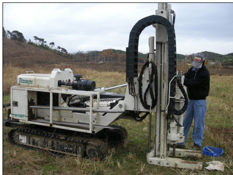
그림 5. 토양시료 채취 장비 및 채취 샘플러
