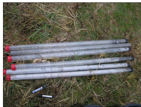
그림 5. 토양시료 채취 장비 및 채취 샘플러
