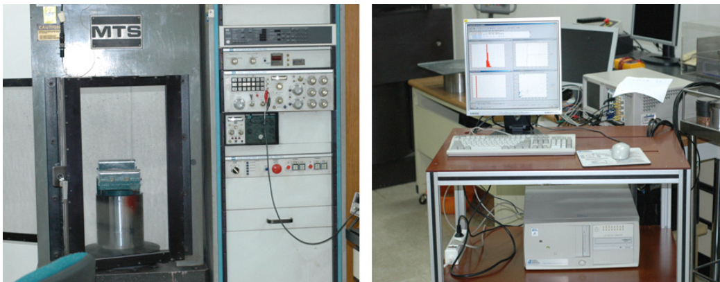
그림 2. 만능시험기와 미소파괴음 측정장치
