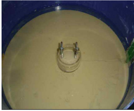
그림 2. a) 자중에 의한 모형 석션버킷관입 b) 모형실험에 사용된 계측장치들
