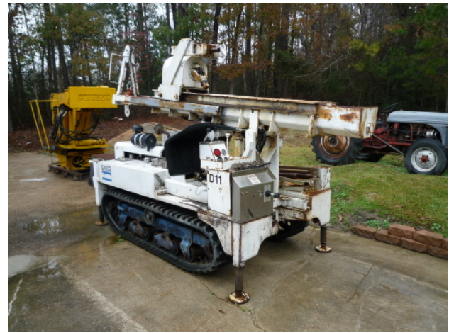
그림 10. MCPT 운반 궤도장치(Gregg Drilling 社)
