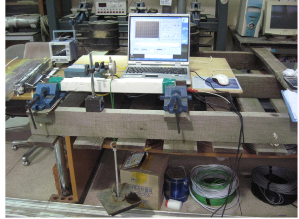
(b) 재하판 및 다이얼게이지 설치
