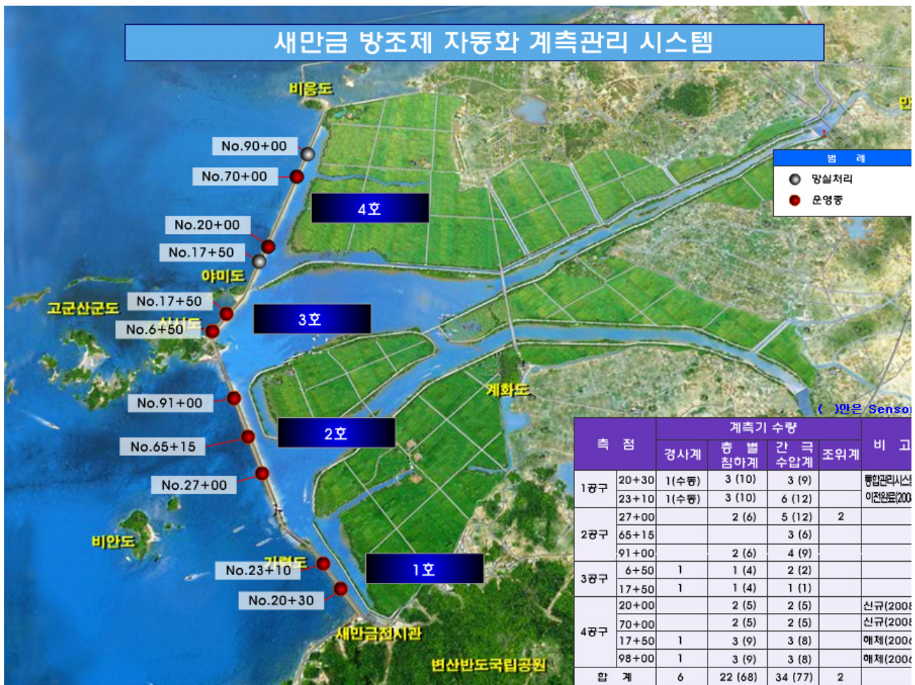
그림 3. 새만금 방조제 자동화 계측관리 현황
