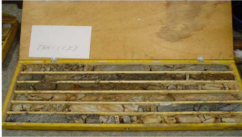
사진 3. 상행선 sta0+628 선진수평시추코아
