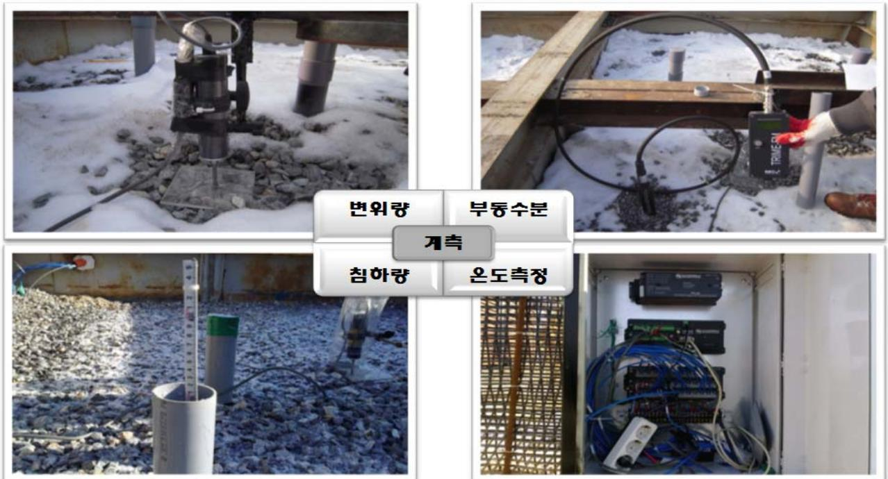
그림 5. 옥외동상시험 시스템 구축현황
