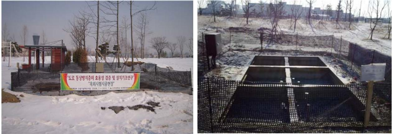
그림 4. 옥외동상시험 시스템 전경
