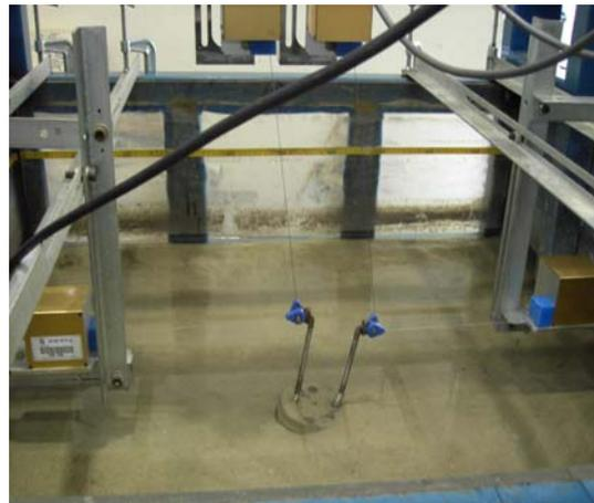
그림 10. 수평인발실험 완료 후 모습
