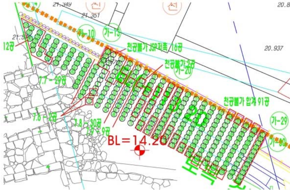
그림 3. 소일-시멘트 컬럼 시공 평면도
