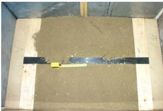
그림 6. 배수암거 매설 및 토압계 설치 광경
