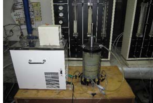
그림 10. 항온 수조를 이용한 등가 투수계수 측정 모습
