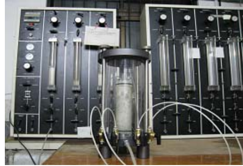
그림 6. 시멘트 그라우트 투수계수 측정
