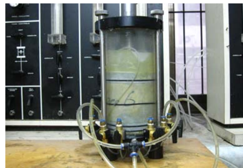
그림 8. 파이프가 삽입된 시멘트 시료의 투수계수 측정
