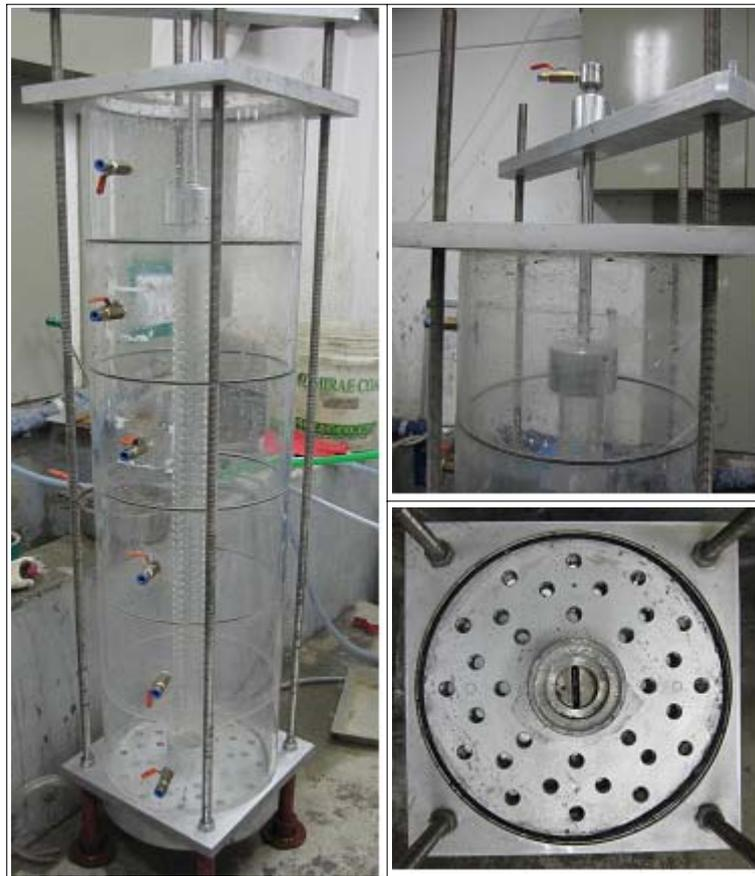
그림 1. 연직배수재를 고려한 대형자중압밀 시험 장비
