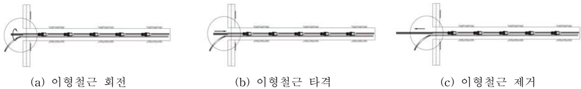
그림 8. 썬기형 제거식 쏘일네일링 공법 제거방법
