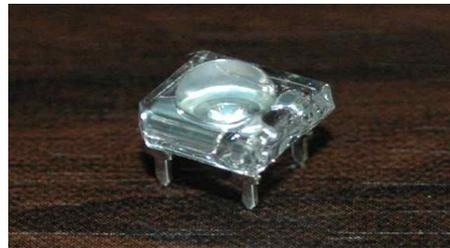
사진.7 Super flux LED
