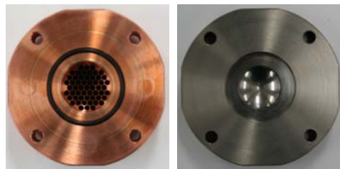
그림 1. 고효율 ^{18}\text{F} Nb 표적 장치의 격자부와 ^{18}\text{O} 캐비티
