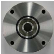
그림 2. 고효율 ^{18}\text{F} Nb 표적 장치의 냉각수 캐비티
